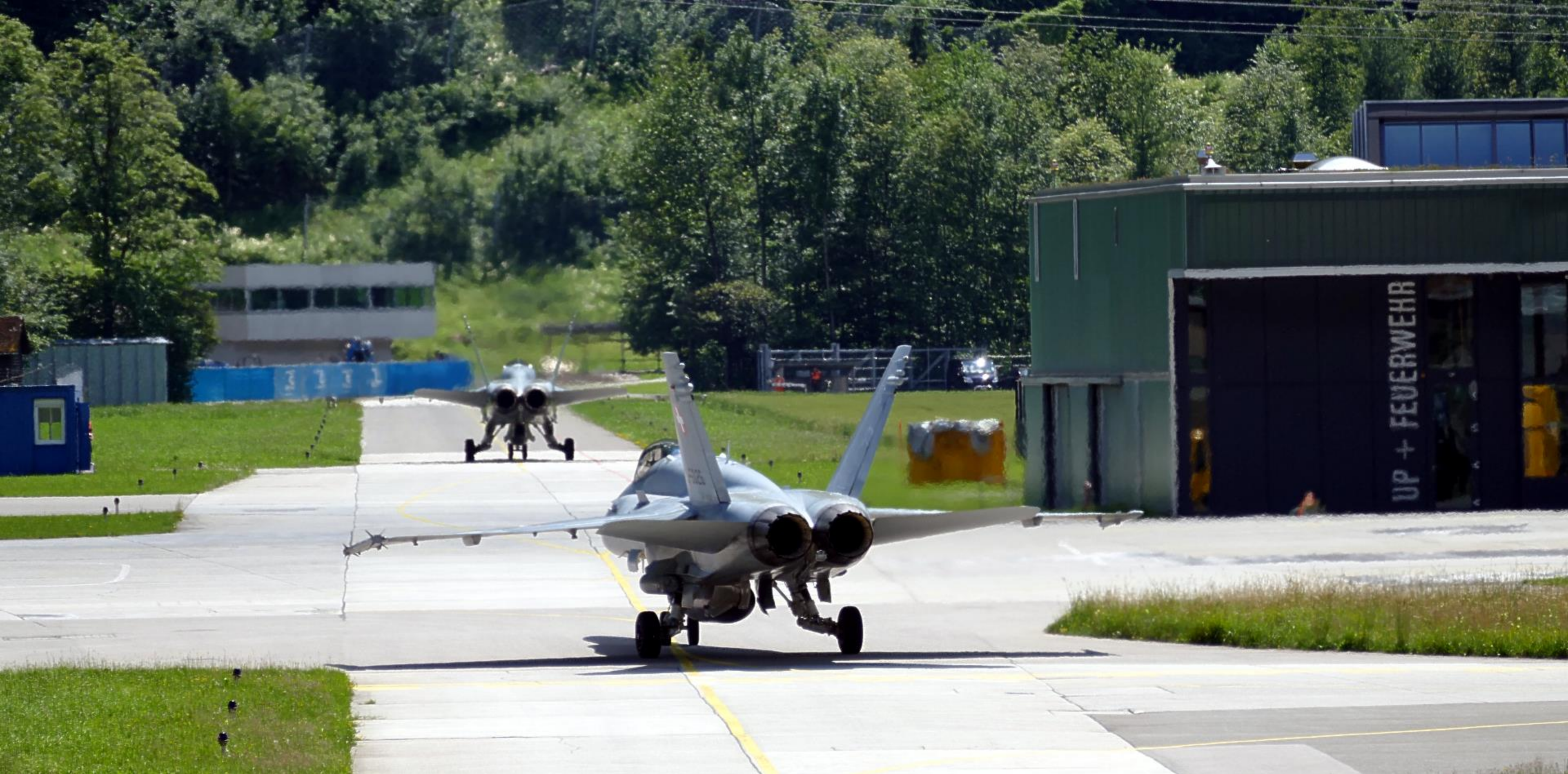
LSMM 19.6.2019 14:34 · Bekannte Situation mit der Rolleistung (Austrittsdüsen fast „offen“).
