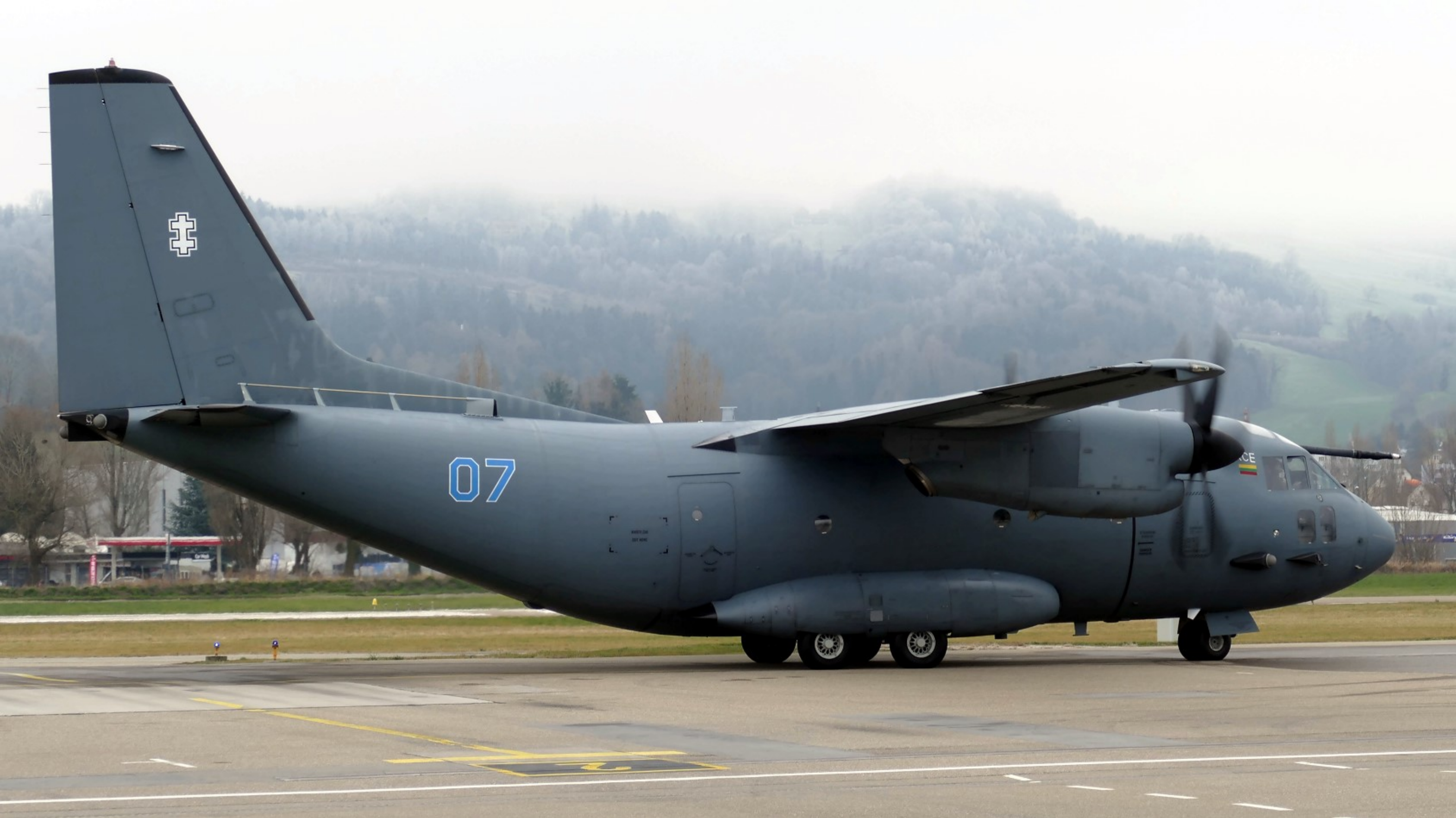
07, Alenia C-27J Spartan, ein militärisches Mehrzweck- und STOL-Transportflugzeug. Max. Startmasse 30500 kg, Spannweite 28,70 m.
